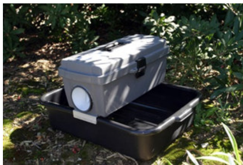
Figura 5: trappola Gravid assemblata e posizionata.
