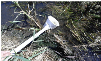
Figura 10: raccolta larvale mediante l'uso di apposito "pescalarve".
